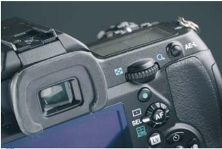
Il mirino ha una copertura pressoché totale del formato, con un ingrandimento dell'immagine di 0,92x. (con 50mm f/1.4 a infinito); è possibile montare un oculare opzionale (Magnifier Eyecup O-ME53) che porta l'ingrandimento a 1,09x. La correzione diottrica va da -2,5 a +1,5 diottrie.
