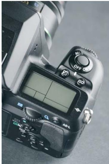
La Pentax K-5 dispone di un ampio LCD di stato di tipo monocromatico. Le informazioni sono complete e consentono di non accedere al ben più dispendioso, in termini energetici, LCD posteriore. La retroilluminazione è verde.
