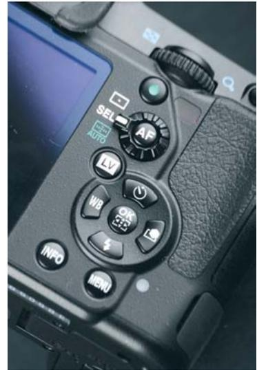
Dall'alto verso il basso: la ghiera di controllo posteriore, il pulsante verde (personalizzabile e che in Manuale consente di regolare l'esposizione in modo automatico, funzione Hyper-Manual), il comando di scelta del sistema di lettura esposimetrica, il comando Live View, il classico pad a quattro direzioni ed infine i pulsanti Info e Menu.
