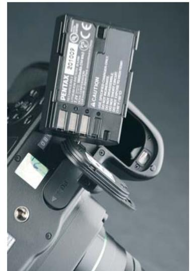
L'alimentazione è fornita da una batteria al litio ricaricabile D-LI90 (7.2V, 1860 mAh).
